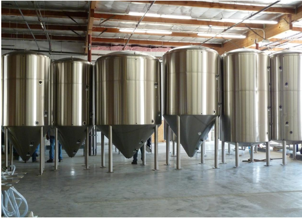
Εικόνα 5.2 Δεξαμενές ωρίμανσης και αποθήκευσης Whirpool
