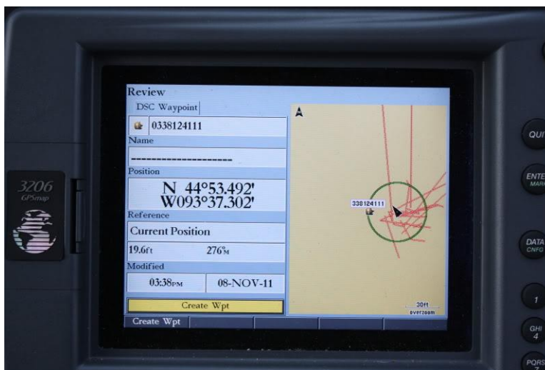
Εικόνα 4: Οθόνη ενός ραντάρ που μας δείχνει στοιχεία του σκάφους όπως τον μοναδικό αριθμό MMSI και τις συντεταγμένες του
