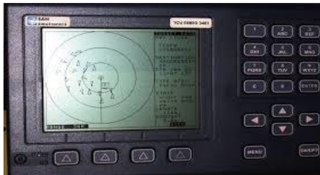
Σχήμα 9: Ένα σύστημα AIS το οποίο παρουσιάζει την κατάσταση και την απόσταση των παραπλέοντων σκαφών
