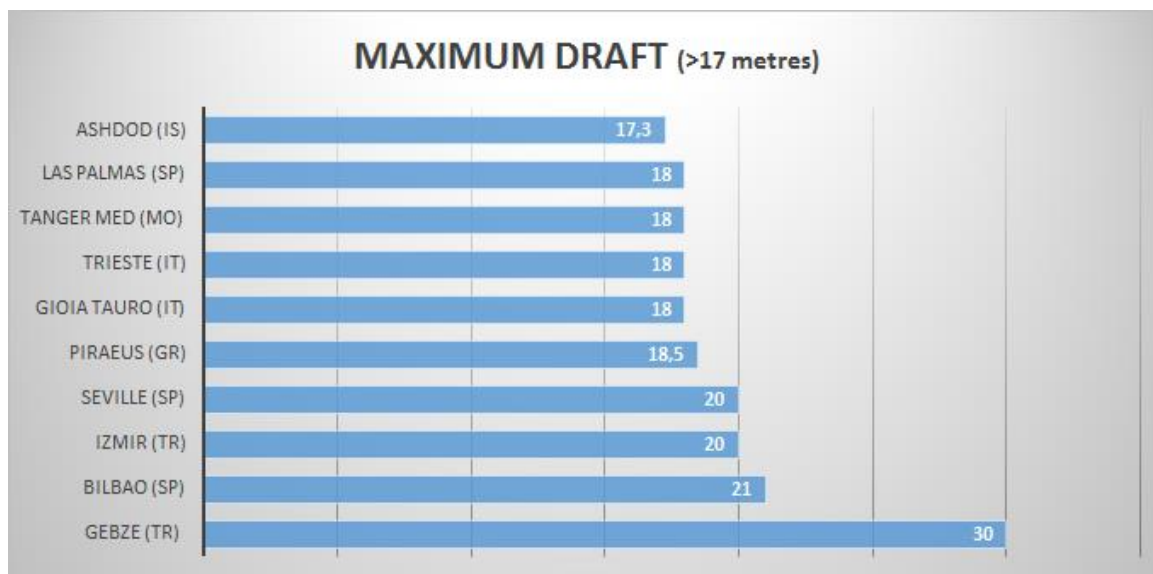
Διάγραμμα 3.11: Τα 10 μεγαλύτερα μέγιστα βυθίσματα μεγαλύτερα των 17 μέτρων (μέτρα)
