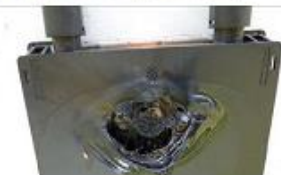
ΦΩΤΟΓΡΑΦΙΑ 12: Επιπτώσεις από κτύπημα κεραυνού επάνω στο φωτοβολταϊκό πλαίσιο.
