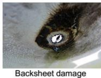
ΦΩΤΟΓΡΑΦΙΑ 12: Επιπτώσεις από κτύπημα κεραυνού επάνω στο φωτοβολταϊκό πλαίσιο.
