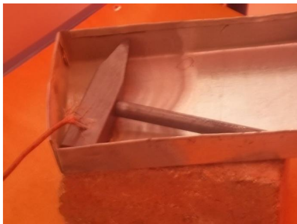
Εικόνα 3.4: Τοποθέτηση ακροδέκτη αισθητήρα
