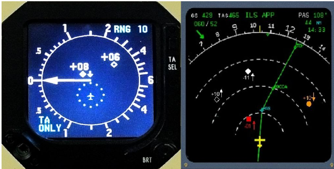
Εικόνα 11 – Συσκευές ενδείξεων του TCAS σε πιλοτήριο του αεροσκάφους
