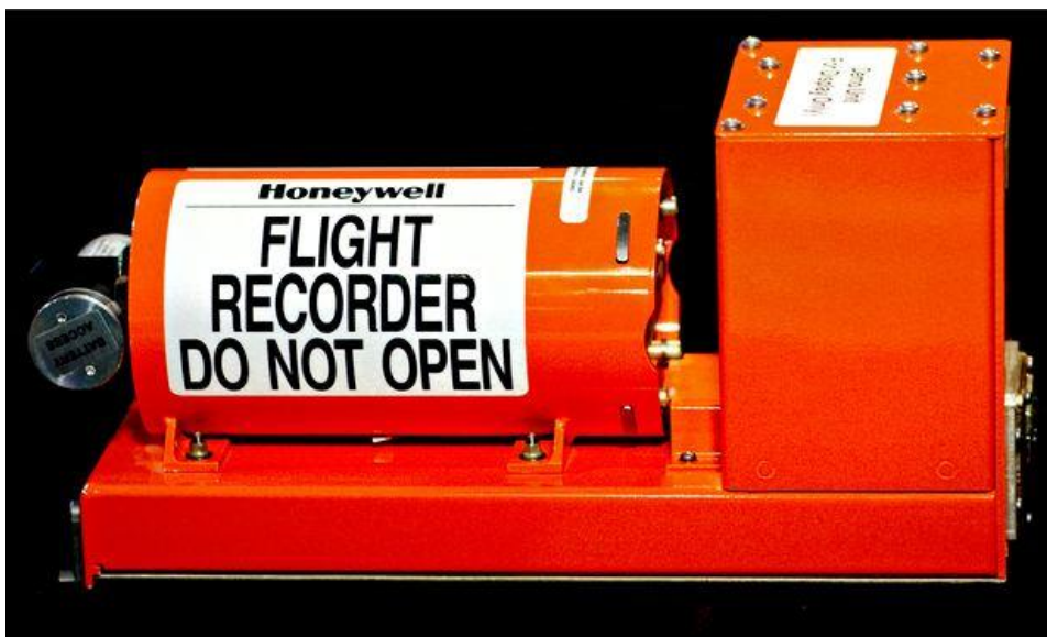
Εικόνα 12 – Μαύρο κουτί καταγραφής πληροφοριών πτήσης ενός αεροσκάφους
