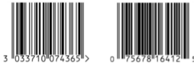
Εικόνα 5.1 – Αριστερό Barcode κατά το πρότυπο EAN-13, Δεξί Barcode κατά το πρότυπο UPC-A ( Πηγή: Physical Mobile Interaction in Omni-Channel Retailing)
