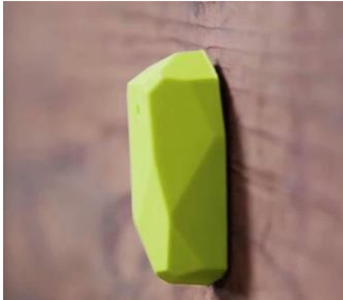
Εικόνα 2.2 – Συσκευή beacon εγκατεστημένη σε κάθετη επιφάνεια (Πηγή: www.agencyrja.com )
