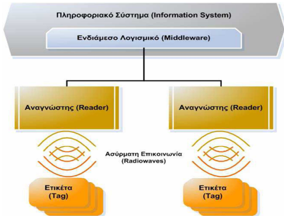
Εικόνα 16 Αρχιτεκτονική συστήματος RFID.
