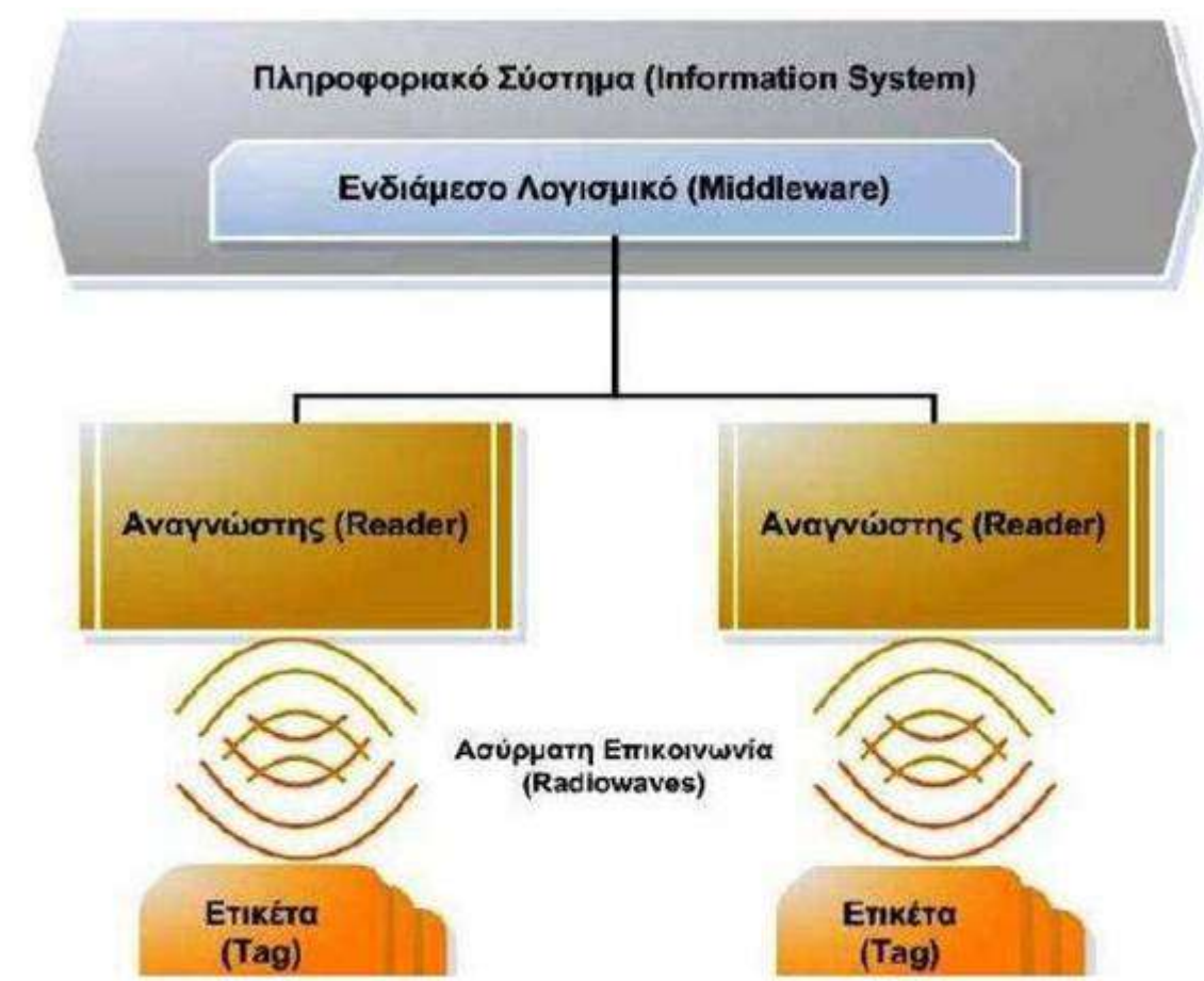
Εικόνα (7): Αρχιτεκτονική συστήματος RFID
