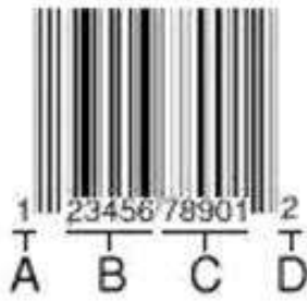
Εικόνα(1): Συστατικά του UPC γραμμωτού κωδικού
