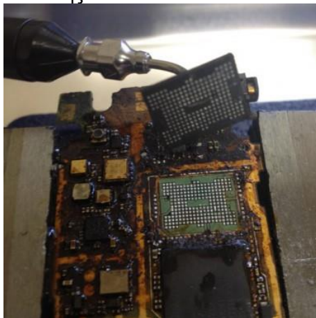
Εικόνα 6 & 7. Απεικονίσεις τεχνικών ανάλυσης (Chip-Off and Jtag techniques)
