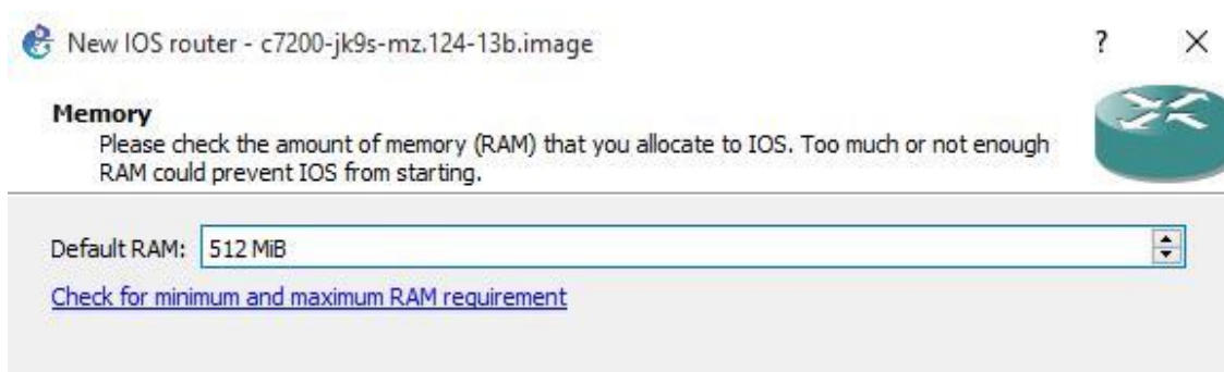
Εικόνα 26. Παραμετροποίηση GNS3 για εισαγωγή router (βήμα 6)
