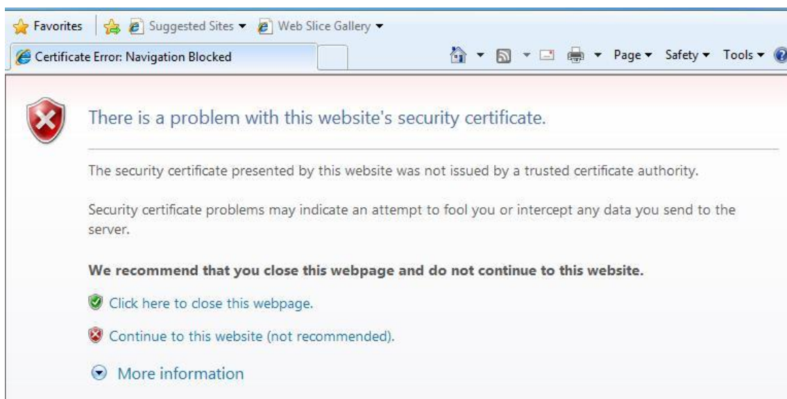
Εικόνα 165. Εικόνα του client όταν προσπαθεί να εισέλθει στην εφαρμογή. Το πιστοποιητικό είναι self-signed και γι'αυτό εμφανίζεται η προειδοποίηση.
