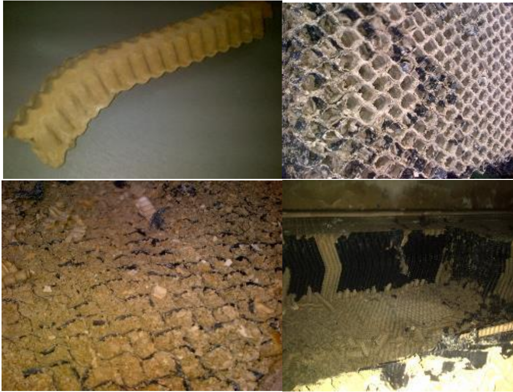
Σχ.15 : αποφρακτική συμπεριφορά επικαθήσεων πάνω στις επιφάνειες διασκορπίσεως εντός του ψυκτικού πύργου
