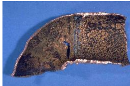
Σχ.14.α: Διάβρωση από πρόσκρουση σε αγωγούς με υψηλή ταχύτητα κυκλοφορίας του μέσου
