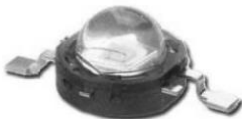
Εικόνα 3.3 GaN phosphorus white led
