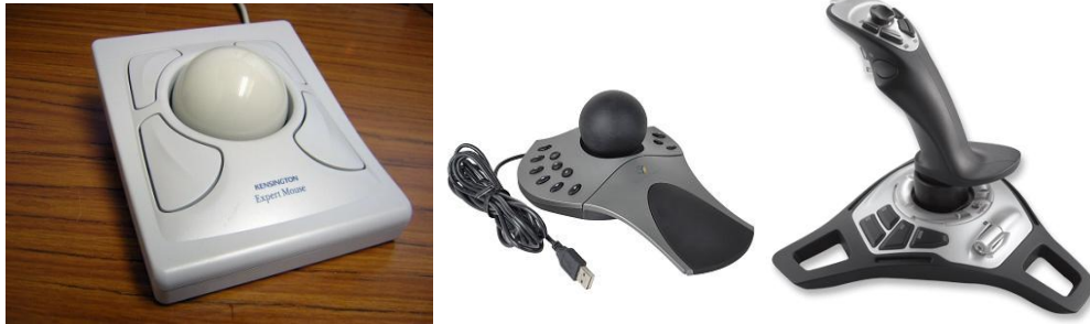
Εικόνα 13: Παράδειγμα trackball (αριστερά), spaceball (κέντρο) και joystick (δεξιά)
