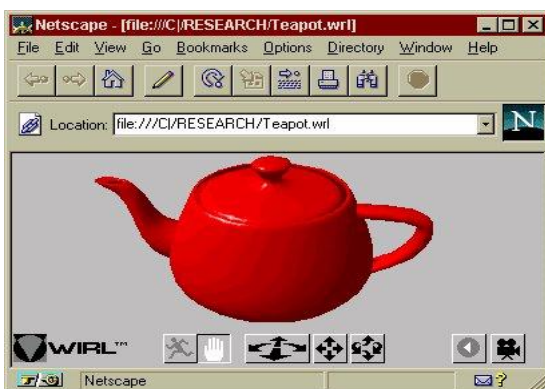
Εικόνα 29: Το τσαγιερό της Utah. Πρωτοκατασκευάστηκε στο πανεπιστήμιο της Γιούτα το 1975 από τον M.Newell. Το πολυγωνικό πλέγμα τσαγιερού έχει γίνει ένα σημαντικό στοιχείο στα κομπιούτερ γραφικών. Αυτή η εκδοχή του VRML περιέχει 1976 κορυφές και 3751 πολύγωνα.
