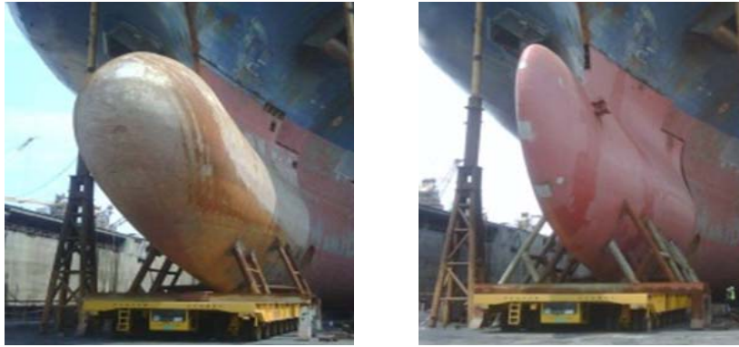
Εικόνα 2.7.: Βολβοειδής Πλώρη πλοίου (εικόνα Α) και η μετασκευή της (εικόνα Β) Πηγή: Danaos Shipping Co.Ltd Photos Gallery.
