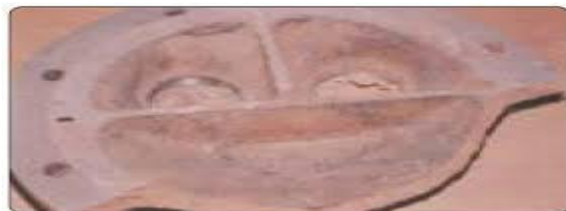
Εικόνα 6 – Αστοχία λόγω Θερμικής Διαστολής σε κεφαλή εναλλάκτη θερμότητας, από χυτοσίδηρο.
