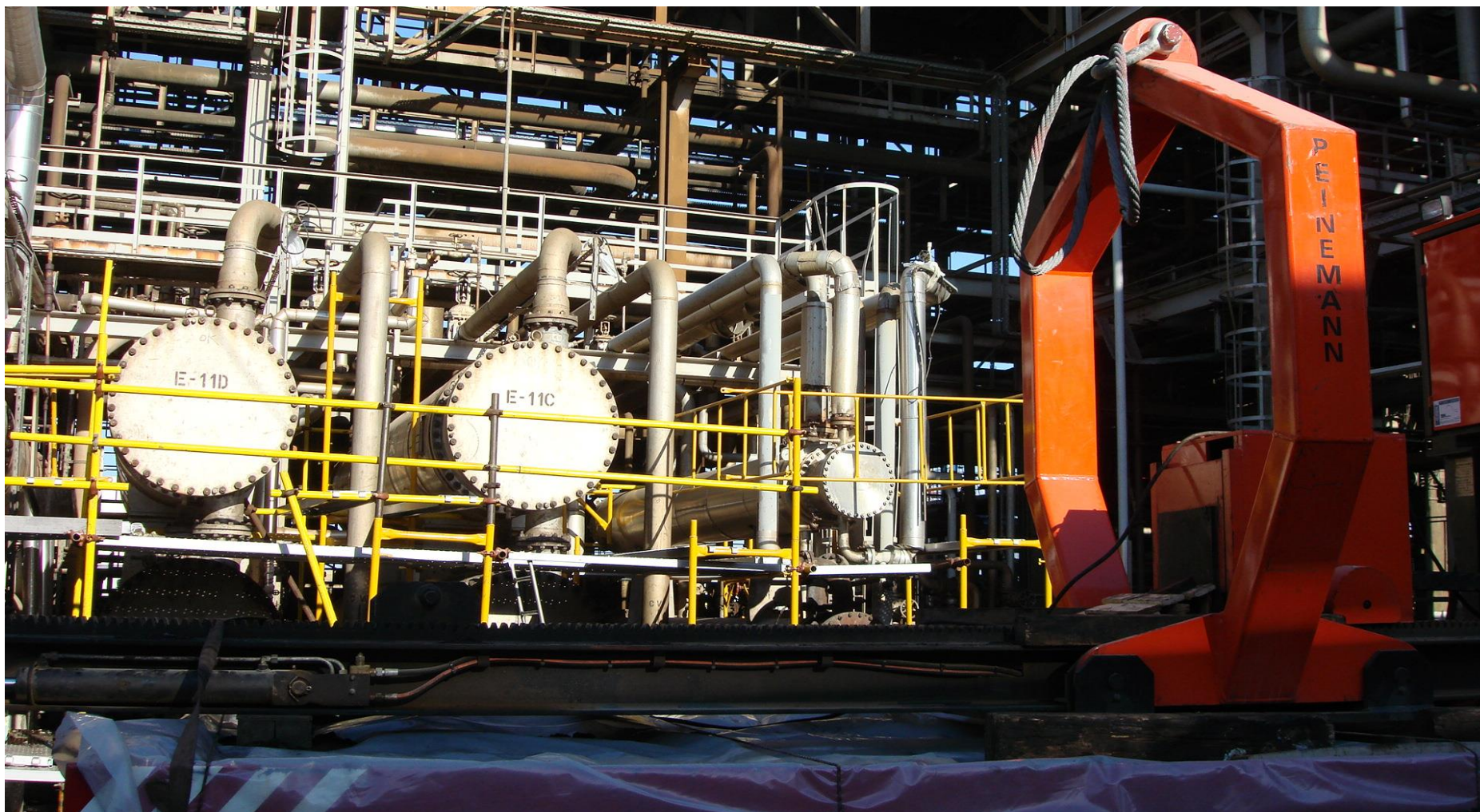
Εικόνα 13 – Μηχάνημα Αποσυναρμολόγησης – Συναρμολόγησης Τουμποστοιχείων Εναλλακτών
