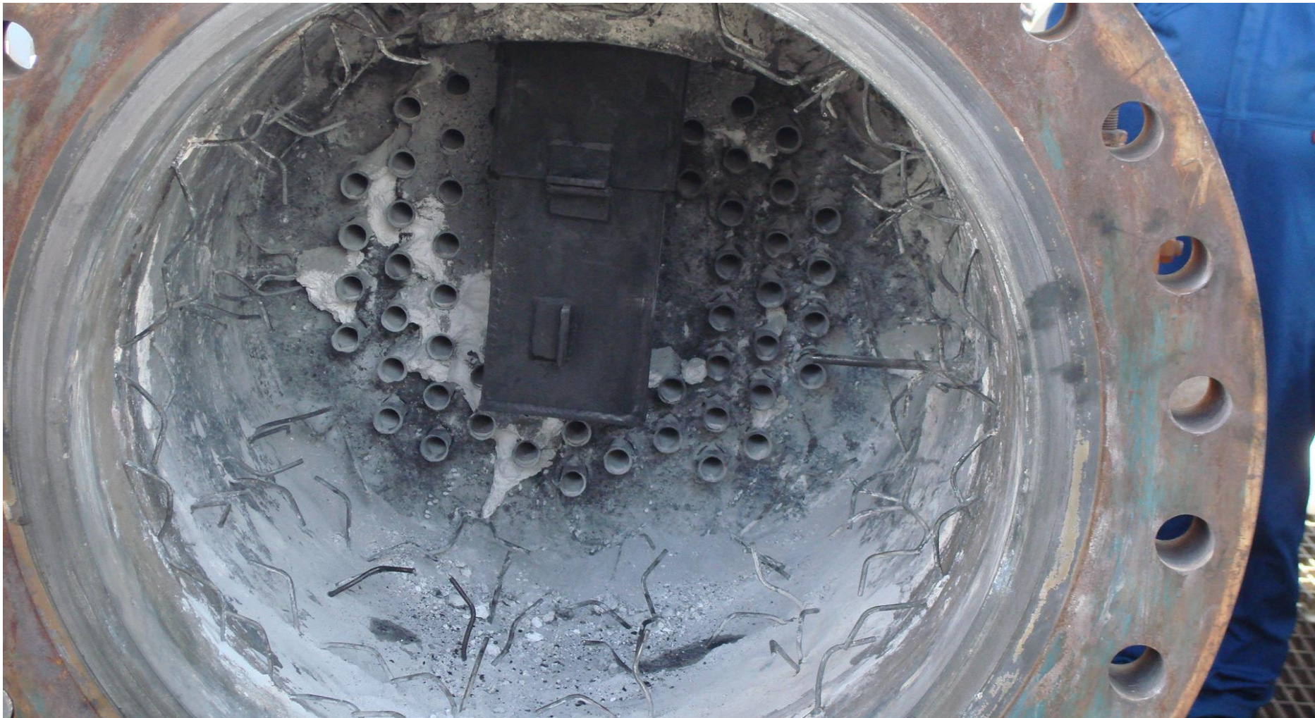
Εικόνα 17 – Βόρειο Στοιχείο Εναλλάκτη (πετρωμένο)
