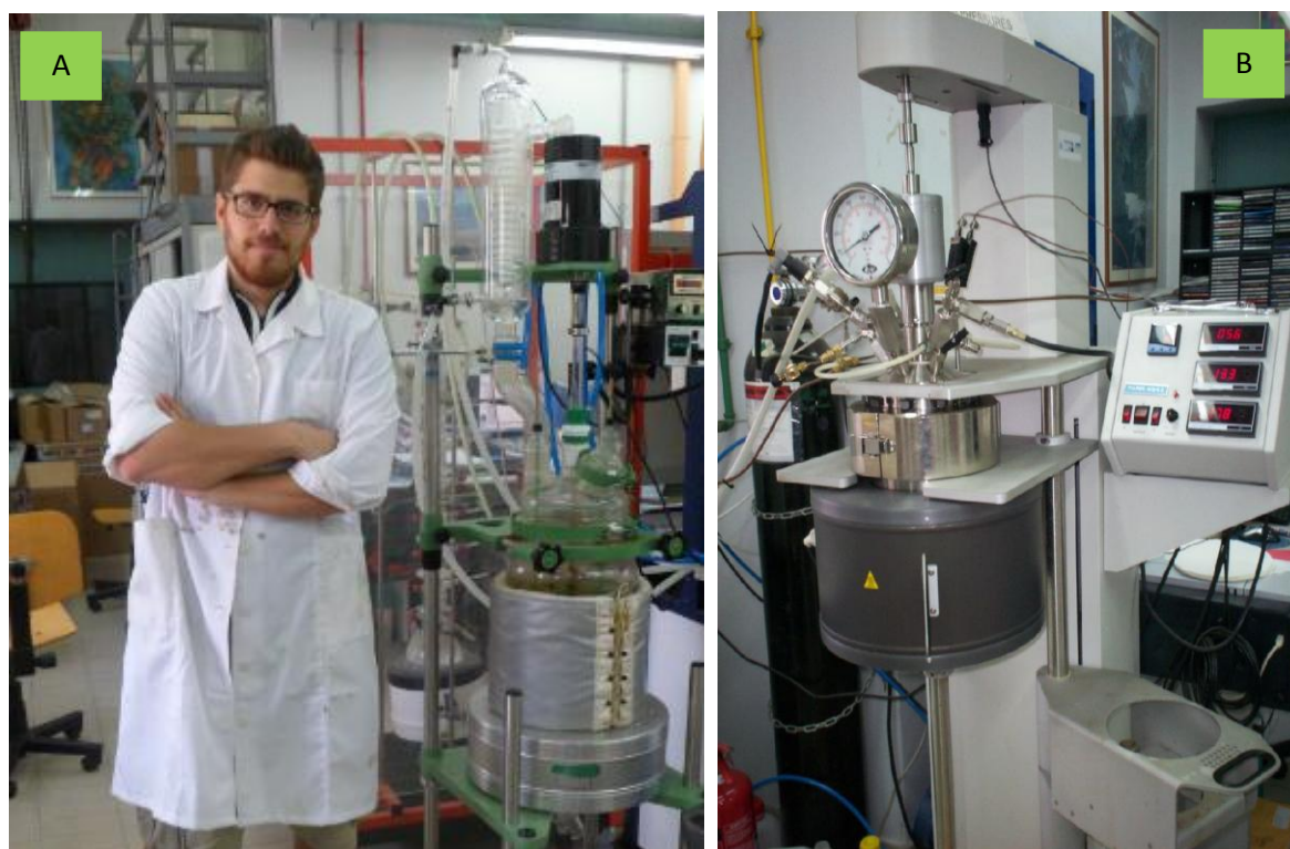
Σχήμα 6-1: (A) Γυάλινος αντιδραστήρας χωρητικότητας 20L (B) Μεταλλικός αυτόκλειστος αντιδραστήρας PARR 4843, χωρητικότητας 3.75L στο εργαστήριο «Προσομοίωσης Βιομηχανικών Διεργασιών»
