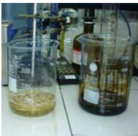
Σχήμα 6-3: Προσρόφηση σε καθαρό πετρελαιοειδές 300 mL (ακατέργαστο άχυρο: αριστερά diesel, δεξιά crude oil)
