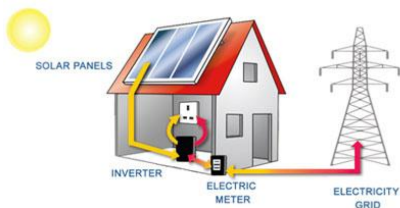
Εικόνα 7: Διασυνδεδεμένο φωτοβολταϊκό σύστημα
