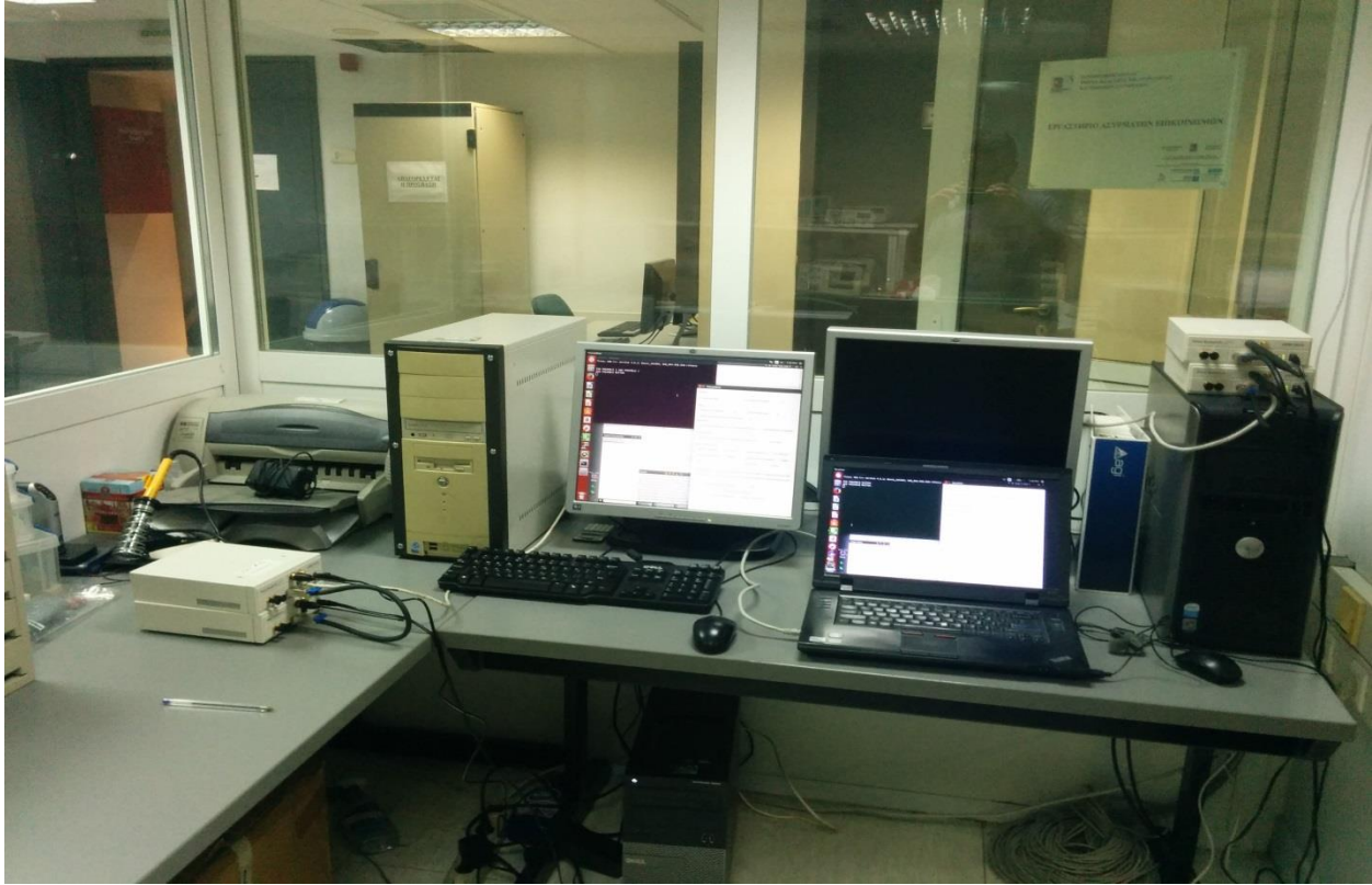
Εικόνα 8.1 – Γενική άποψη του συστήματος SDR MIMO 2x2 που αναπτύχθηκε στο εργαστήριο. Αριστερά διακρίνεται ο υπολογιστής – host του πομπού και δεξιά ο υπολογιστής host του δέκτη, κάθε ένας εκ των οποίων είναι συνδεδεμένος με 2 συσκευές USRP.
