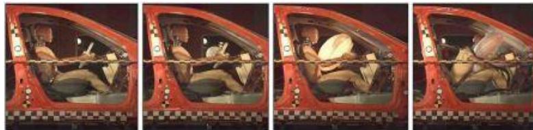
Εικόνα 20. Ο χρόνος πλήρους ανοίγματος του αερόσακου είναι βασικό χαρακτηριστικό ποιότητας, άμεσα συνδεδεμένο με την ασφάλεια
