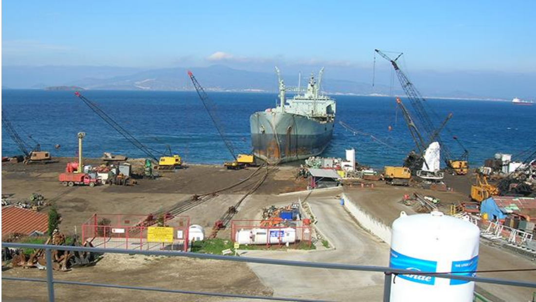
Εικόνα 3: Μέθοδος slipway στις εγκαταστάσεις της Leyal
