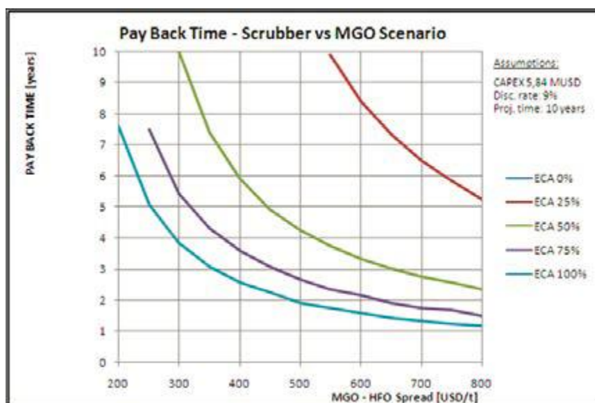
Διάγραμμα 9: Σύγκριση των δύο εναλλακτικών συμμόρφωσης ως προς το payback period για διαφορετικούς χρόνους έκθεσης σε ECA
