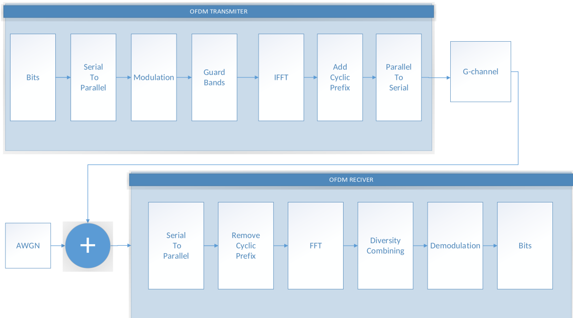
Σχήμα 7: Μπλοκ διάγραμμα πομπού-δέκτη OFDM
