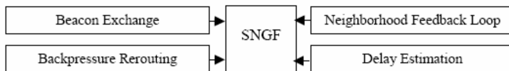
Σχήμα 2.10 Τα συστατικά του πρωτοκόλλου δρομολόγησης SPEED
