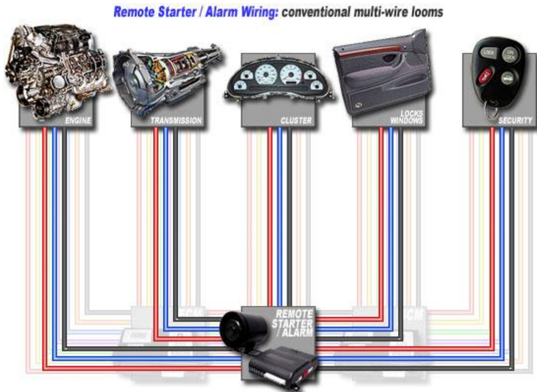
Εικόνα 6. Τυπική καλωδίωση συναγερμού αυτοκινήτου πριν απο την καθιέρωση του CANbus.
