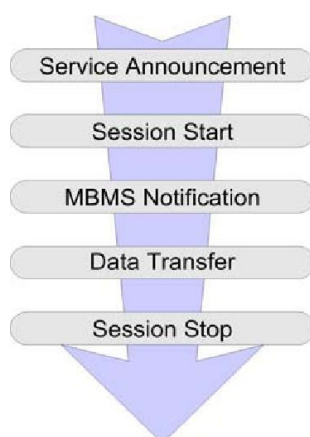
Εικόνα 13: Οι φάσεις της broadcast λειτουργίας
