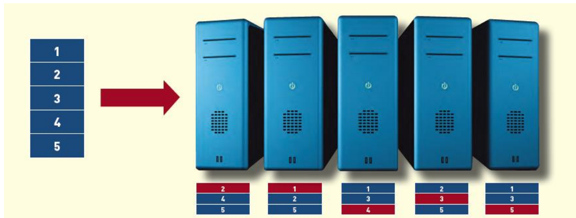
Εικόνα 2.4.1: Με μπλε χρώμα απεικονίζεται η διεργασία όπως χωρίζεται σε μπλοκ απο το HDFS, και με κόκκινο το MapReduce συγκεντρώνει τα αποτελέσματα.[1]
