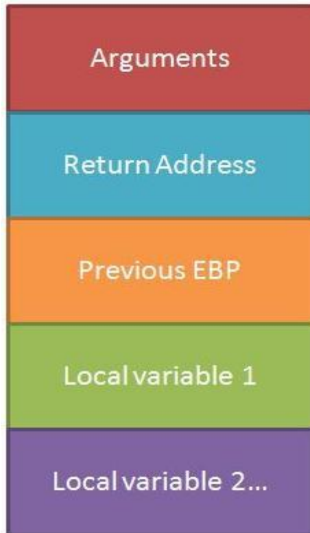
Εικόνα 73 - Δομή ενός Stack frame
