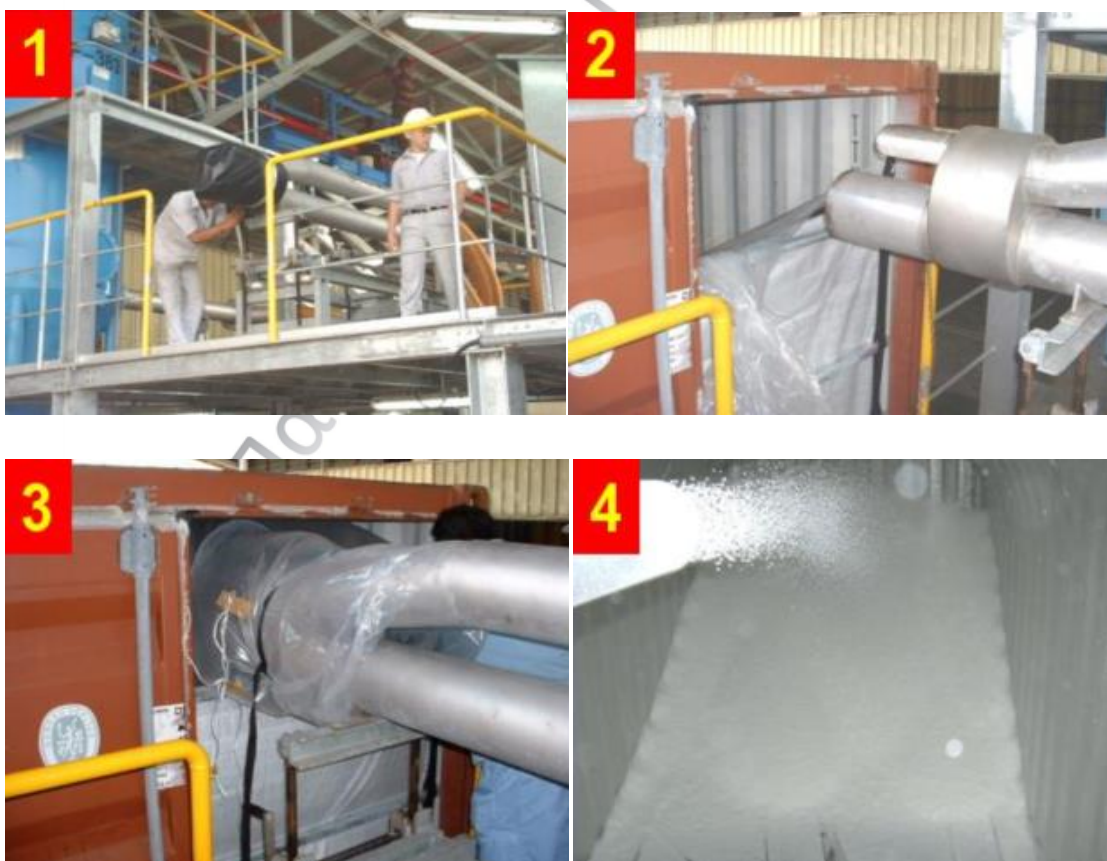
Εικόνα 4.5.1.2 Διαδικασία φόρτωσης χύδην ξηρού φορτίου
