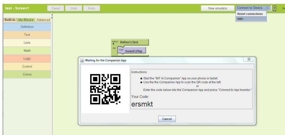
Εικόνα 29: Ασύρματη σύνδεση App Inventor με κινητή συσκευή μέσω Wi-Fi
