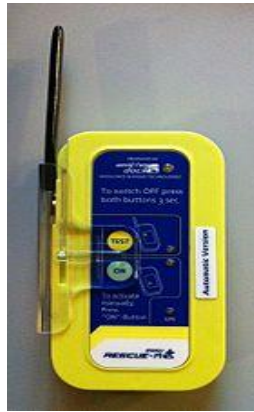
Εικόνα 3-4: Συσκευή αναμετάδοσης SART
