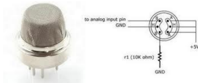
Εικόνα 4-8 Schematic συνδεσμολογίας αισθητηρίου GAS MQ-2
