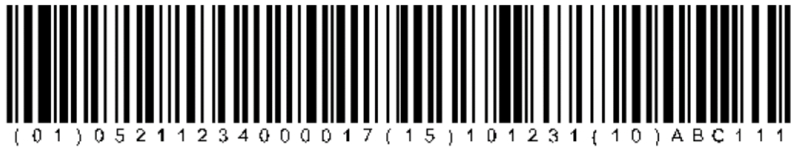
Εικόνα 2.2.4.2 Παράδειγμα συμβόλου GS1-128 που απεικονίζει έναν GTIN, μία Ημερομηνία Ανάλωσης Κατά Προτίμηση και έναν Αριθμό Παρτίδας
