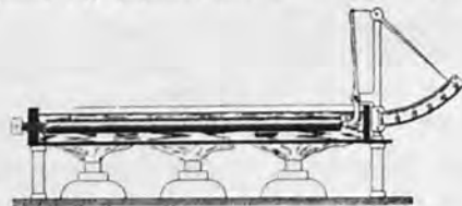
Σχ. 5. Συσκευή μετρήσεως τοῦ συντελεστοῦ γραμμικῆς διαστολῆς στερεῶν
