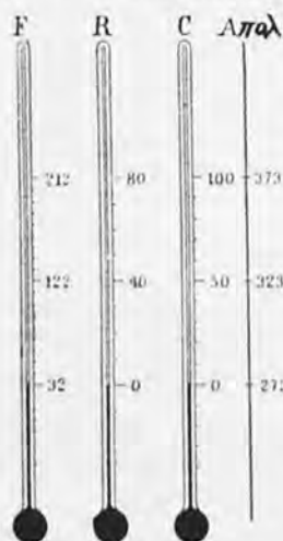
Σχ. 1. Θερμομετρικαὶ κλίμακες, ὅπου σημειώνονται τὰ ἀντίστοιχα βασικά σημεία θερμοκρασίας.
