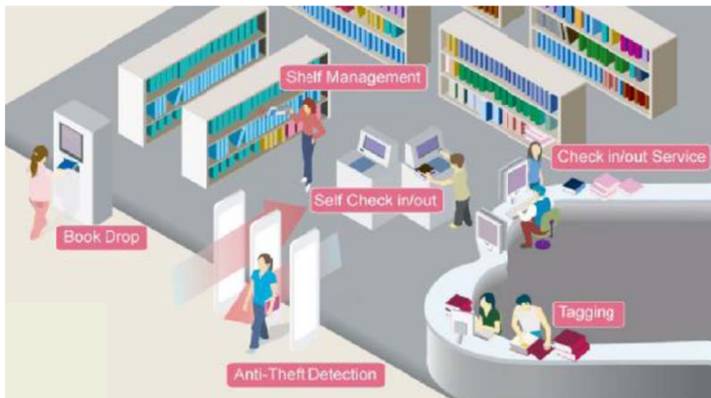
Σχήμα 3.3 Απεικόνιση της λειτουργίας μιας βιβλιοθήκης με τη χρήση της τεχνολογίας RFID
