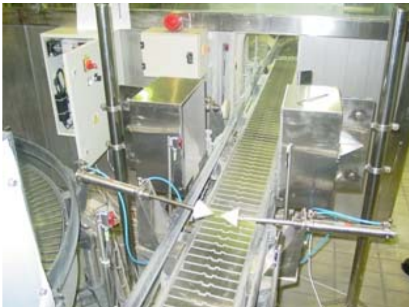
Σχήμα 4.1 Η πύλη αυτόματου μηχανισμού απόρριψης φιαλών
