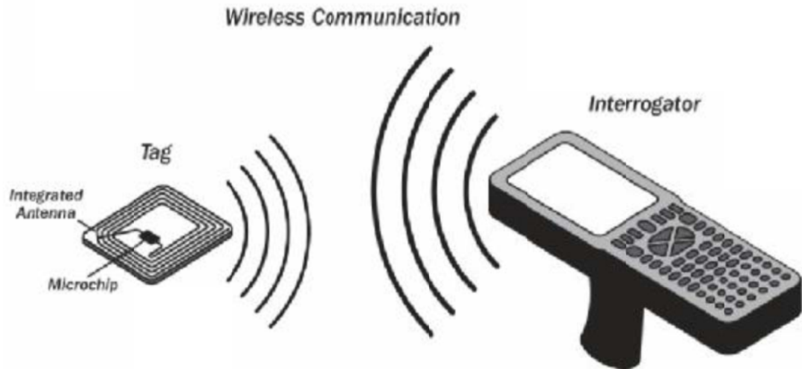
Σχήμα 2.3 Στοιχειώδες RF υποσύστημα.
