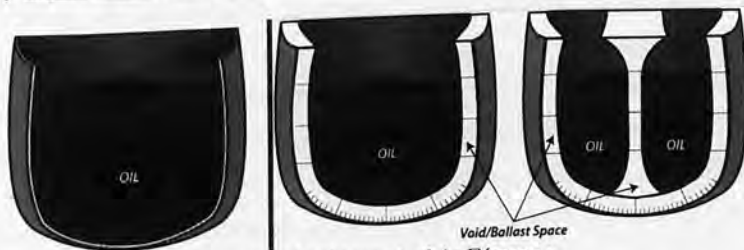
Εικόνα 7: Τομές Δεξαμενών Μονής και Διπλής Γάστρας
