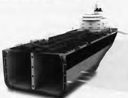
Εικόνα 6: Τομή Δεξαμενόπλοιου Διπλής Γάστρας (Double Hull Tanker-DHT)
