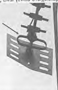
Εικόνα 30 Κεραία Yagi-Uda με ανακλαστήρα και αναδιπλωμένο δίπολο (βέλος)
