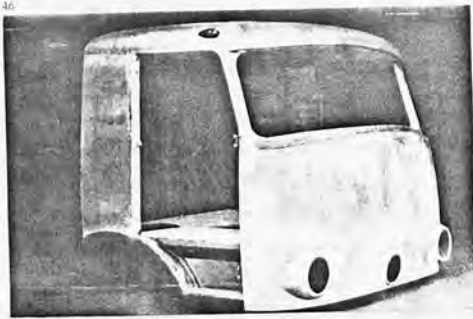
ΕΙΚΩΝΒ-ε. Αμαξώματα αυτοκινήτων, έξ ένισχυμένου δι' ύαλοβάμβακος πολυεστέρος.
