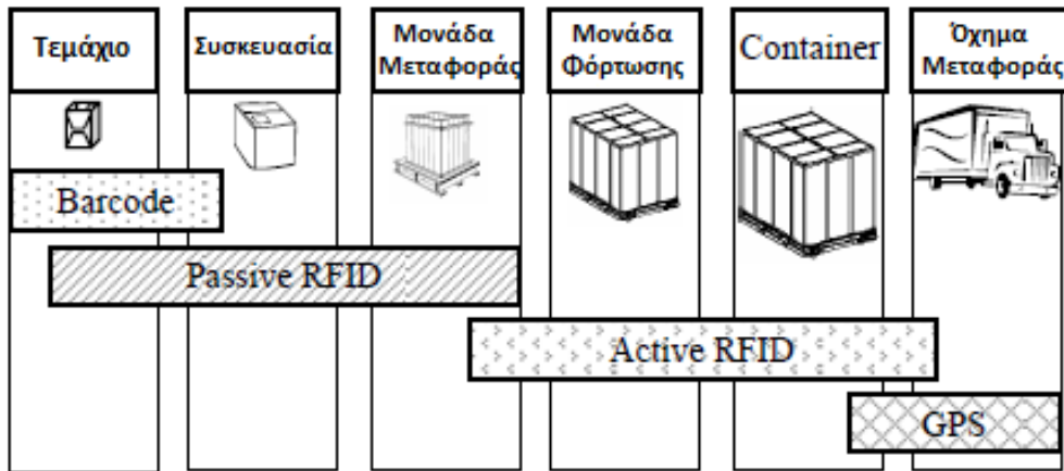
Σχήμα 3.5, Δυνατότητες παράλληλης χρήσης διαφορετικών τεχνολογιών ιχνελασιμότητας (Πηγή: 'Traceability of Material Flow by use of RFID Technology')
