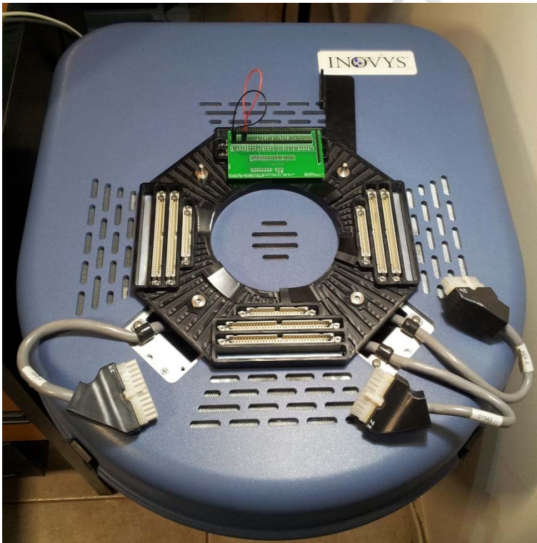
Εικόνα 5. Ελεγκτής Inovys Personal Ocelot
