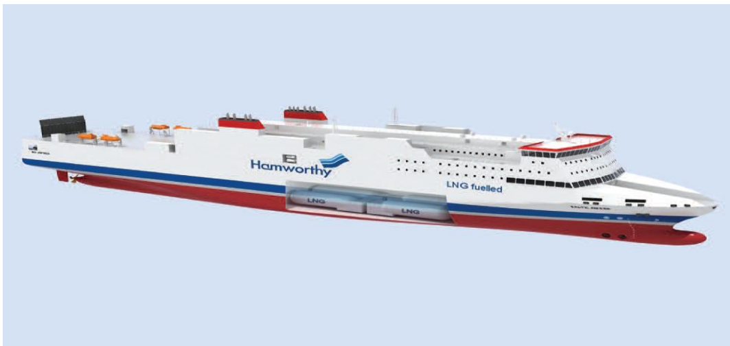
Εικόνα 8: Ε/Γ - Ο/Γ πλοίο που χρησιμοποιεί το LNG ως καύσιμο πρόωσης
