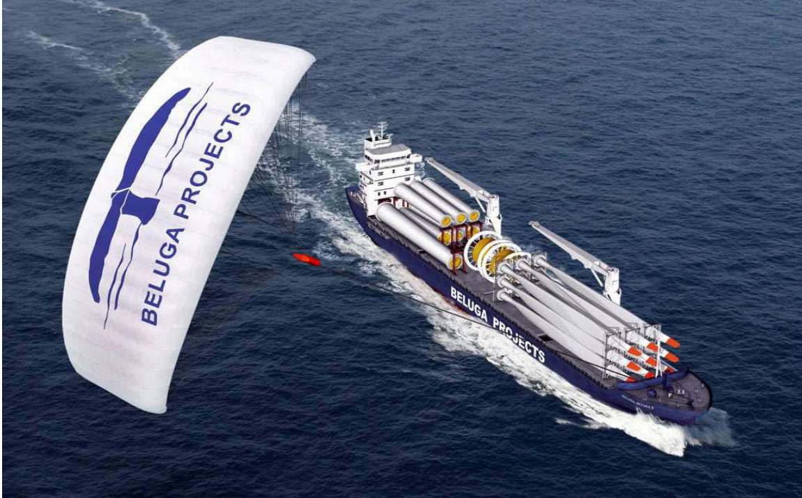
Εικόνα 4.1-10: «Αετοί βοηθητικής πρόωσης «SKYSAILS» 94
