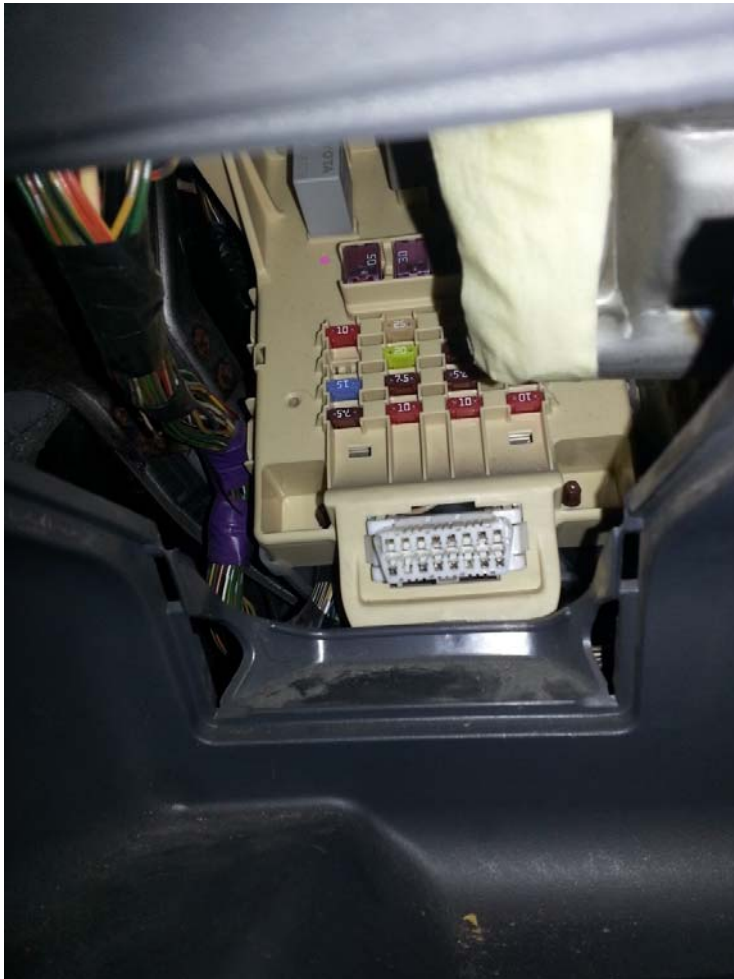
Εικόνα 21: Θύρα OBD II σε TOYOTA YARIS μοντέλο 1999.
