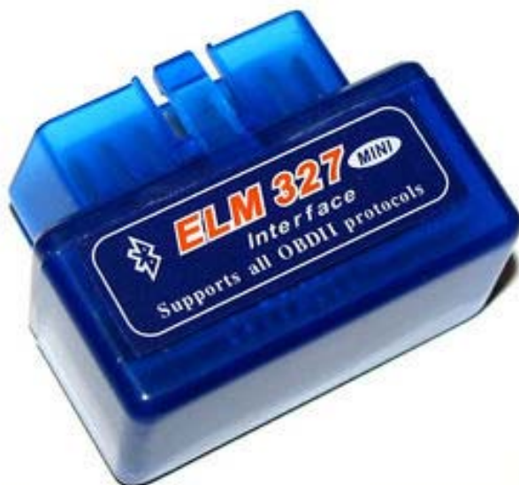
Εικόνα 23: Ασύρματη συσκευή ανάγνωσης μηνμάτων του OBDII μέσω Bluetooth.
