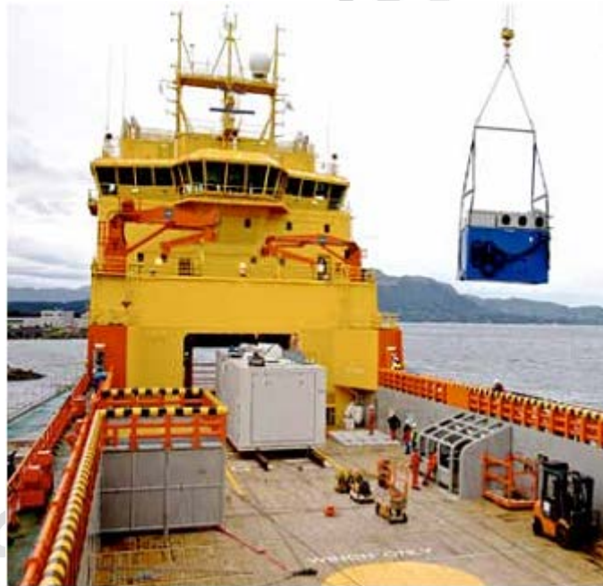
Εικόνα 8: Εγκατάσταση κυψελών καυσίμων
