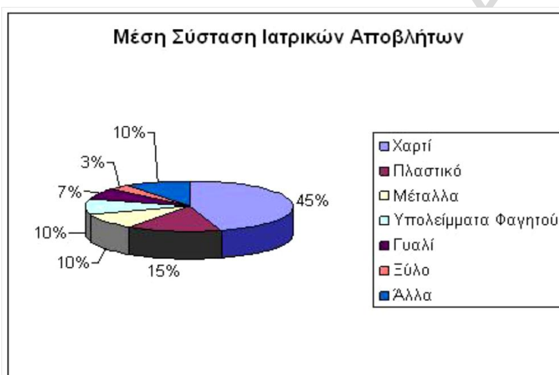
Εικόνα 2.1: Σύσταση μη επικίνδυνων ιατρικών αποβλήτων
