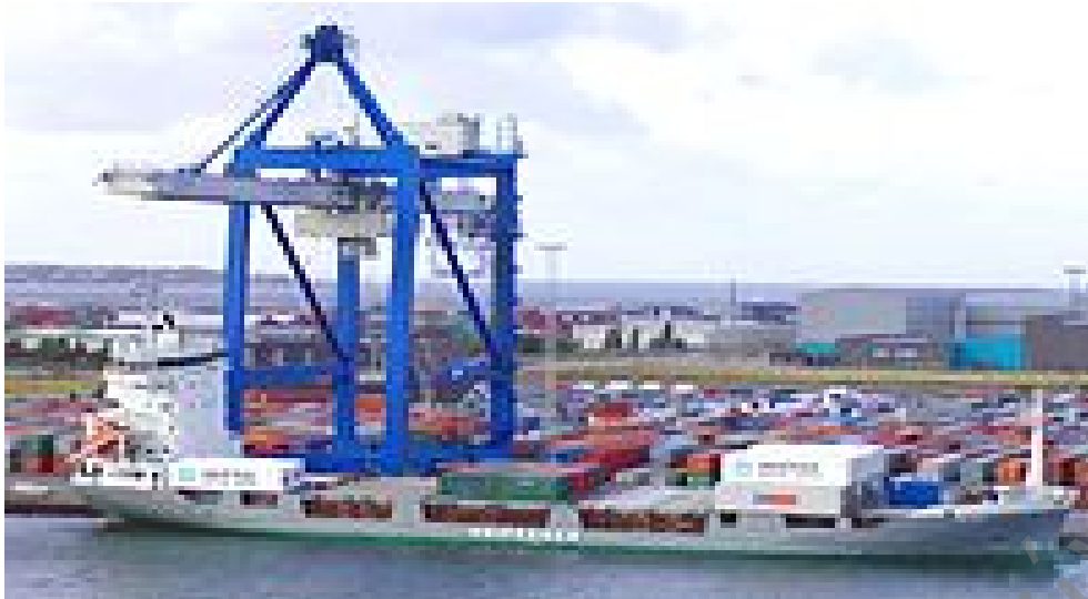
Εικόνα Νο.2 - Πλοίο Μεταφοράς Εμπορευματοκιβωτίων και Τρόπος Φόρτωσης
