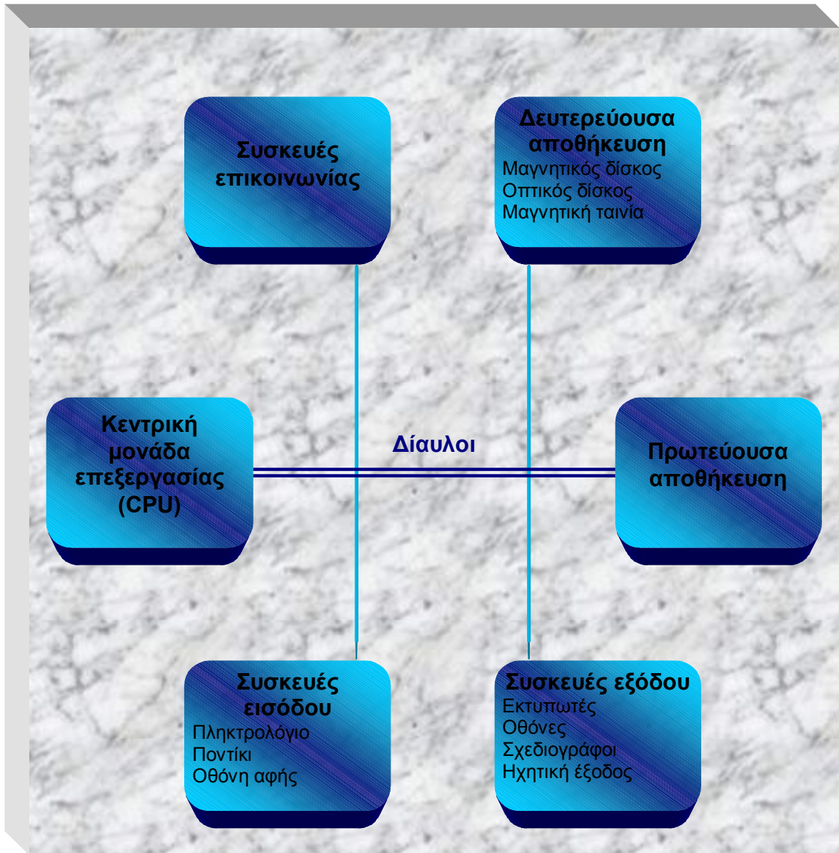
Διάγραμμα 3.2: Τα στοιχεία υλικού ενός συστήματος υπολογιστή.
