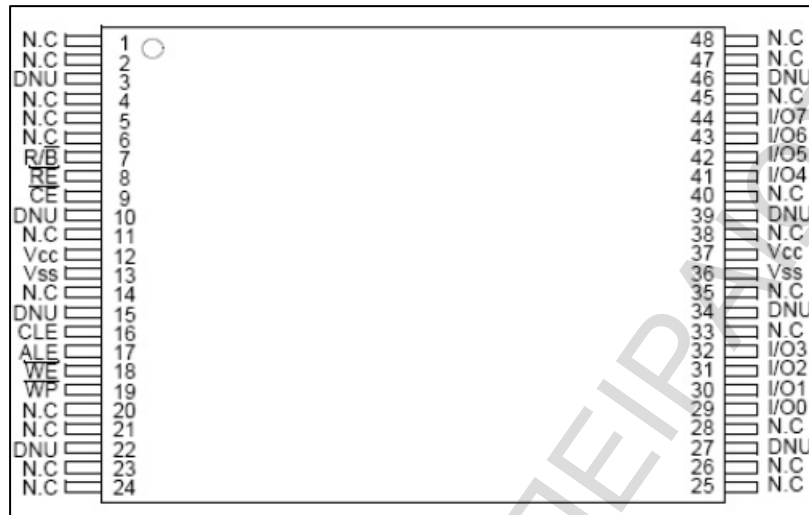
Εικόνα 3.2: Ηλεκτρικές Επαφές Μνήμης NAND Flash
