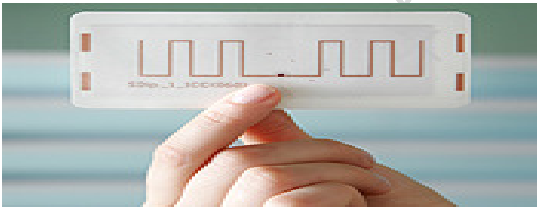
Εικόνα 11. Μορφή RF πλακιδίου-Radio Frequency chip
